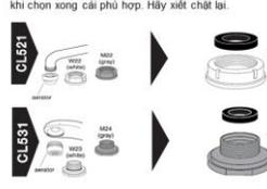
**Bước 3** Áp thiết bị lọc nước (GSFPE:CSF601 MD101) vào đầu vòi, sau đó kéo vòng trắng xuống và xiết chặt. Đây là thao tác cuối cùng.
